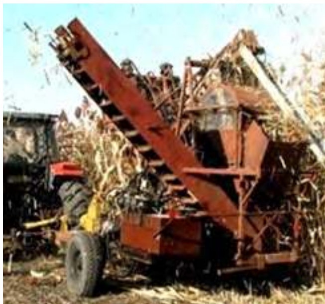
Figura 1. Combina de recoltat sorg zaharat elaborată în cadrul Institutului „Mecagro”
