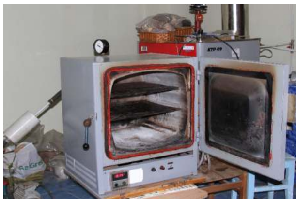
Figura 2. Cuptor de condiționare în vid, folosit la torefierea și condiționarea biomasei: 1 – ușa etanșabilă pivotantă a cuptorului, 2 – carcasa cuptorului, 3 – gura de evacuare a aerului cu vacuometru, 4 – suport termostaț, 5 – rafturi, 6 – panou de comandă și control regimuri termice, 7 – pompă de vid
