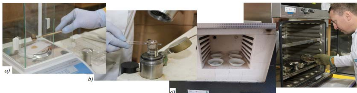
Figura 3. Secvențe din timpul testării biomasei de cătină albă: a) cântărirea probelor la balanța analitică AS 220/C/2, RADVAG, b) determinarea valorii calorifice superioare cu bomba calorimetrică LAGET MS-10A; c) uscarea probelor în etuva UNB 500-Memmert pentru determinarea conținutului de umiditate; d) determinarea conținutului de cenușă în mufla LH-05/13
