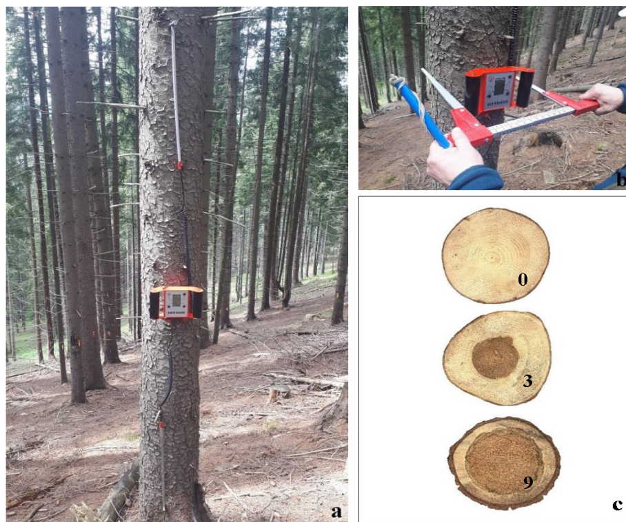
Figura 1. Dispozitivul Rotfinder® (a, b), valori indicate de acesta și proporția lemnului afectat de putregai de rădăcină (c)
