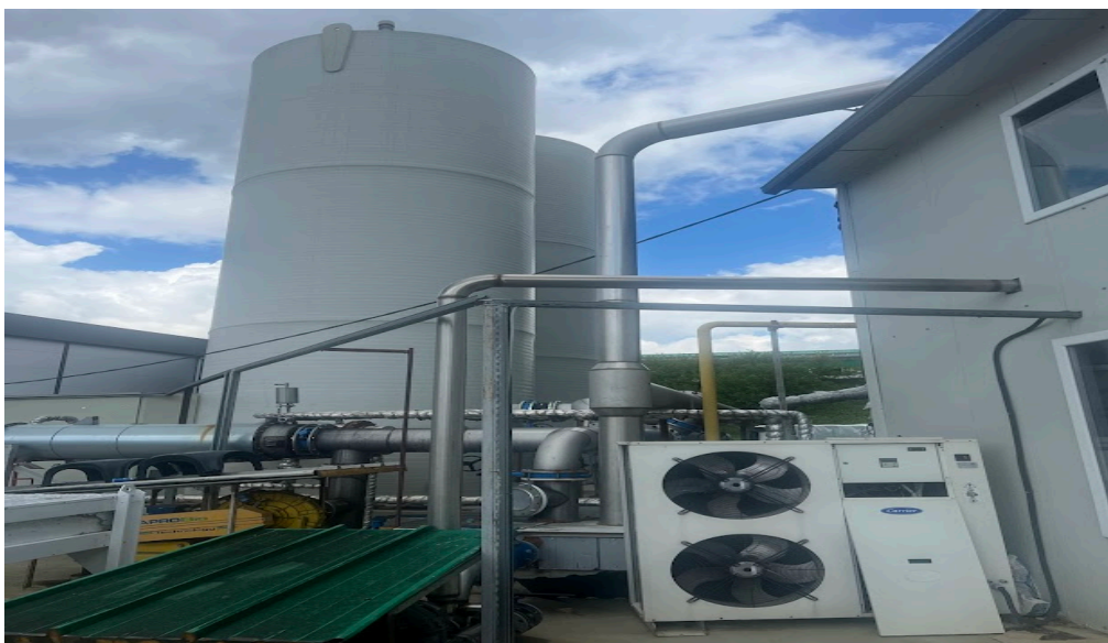
Figura 5. Instalația de purificare a biogazului din cadrul întreprinderii SRL „Garma Grup”.
