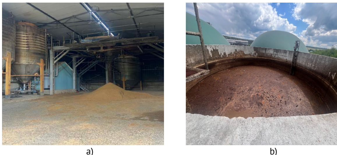
Figura 2. Zona tehnologică de pregătire a substratului (a) și colectarea borhotului de cereale și realizarea amestecului de fermentare (b).
