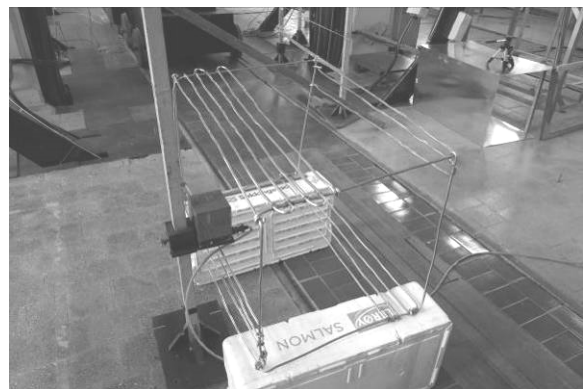
Рис.8. Многоконтурный пассивный экран экспериментальной установки гибридного активно- пассивного экранирования. 8
