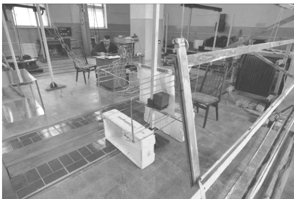
Рис.7. Схема расположения обмотки активного экрана и многоконтурного пассивного экрана. 7
